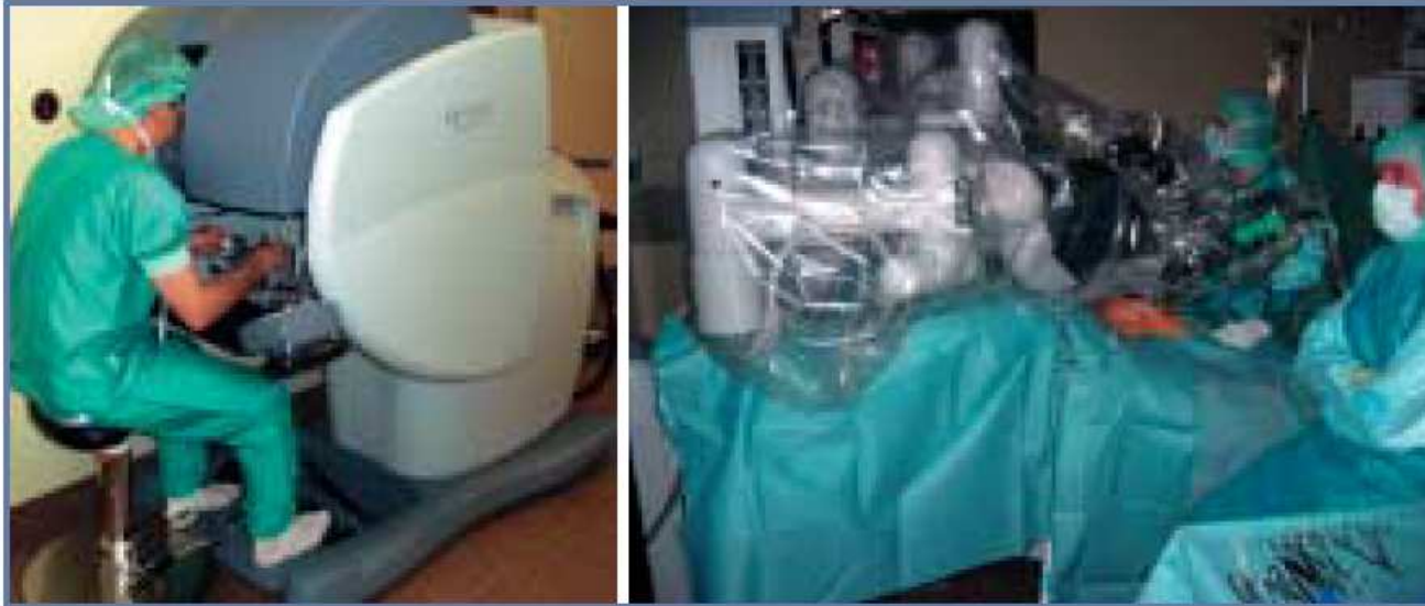
Abbildung 1: Die Da-Vinci-Technologie besteht aus einer Arbeitskonsole (links) und dem Roboterstativ (rechts). Das Stativ hält die Kamera und zwei bis drei Instrumentenarme. Der Chirurg führt die Instrumente von der Konsole mit dreidimensionaler Sicht und voller Bewegungsfreiheit.
